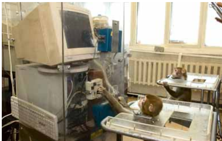
Почему необходимо держать обезьян в приматологических креслах? Именно так имитируется гипокинезия, неизбежная при длительных межпланетных перелетах. Однако приматологическое кресло не фиксирует обезьяну намертво – оно только лишает макаку возможности совершать активные движения, вынуждая ее находиться примерно в одном положении
